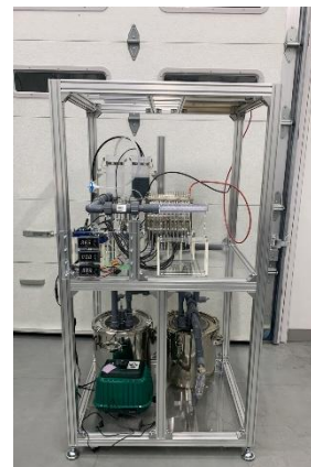
発電システム 水素充填済みの液体水素キャリアをセルスタックに注入するのみで電気エネルギーへの変換が可能
